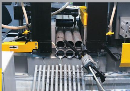
↑ Пример пакетной порезки заготовок на станке СЛП-8535-АВТО в автоматическом режиме
