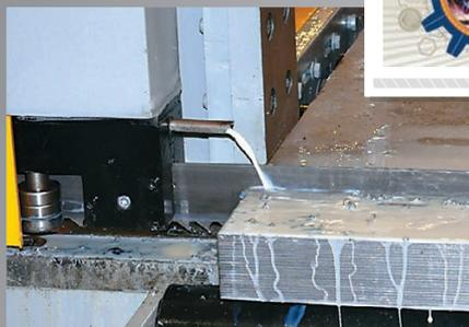
↑ Порезка заготовки шириной 1000 мм на станке СЛП-85100
